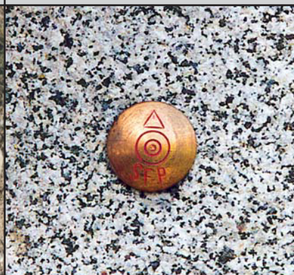
SFP Messingbolzen Ø 3 cm
